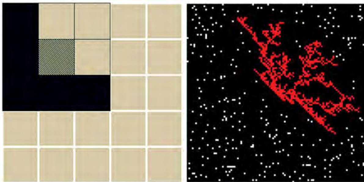
Figura 12: Ottimizzazione della Crescita tramite DLA: Nuovo Sviluppo, dal lato Sottovento, dello Sviluppo Esistente a sinistra: se le cellule in nero, situate sopravento, sono sviluppate, la cellula centrale del contorno risulta sviluppata b) a destra: risultato tipico del processo generativo
